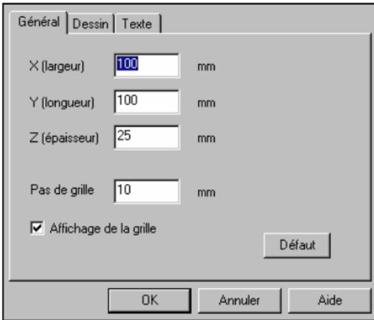
1- Au démarrage du module CFAO3d de Charly Graal il faut choisir les dimensions du brut dans lequel nous allons usiner la pièce.
